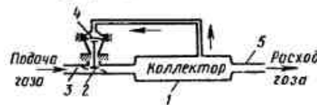
Рис. 28. Принципиальная схема автоматического регулирования давления газа:
